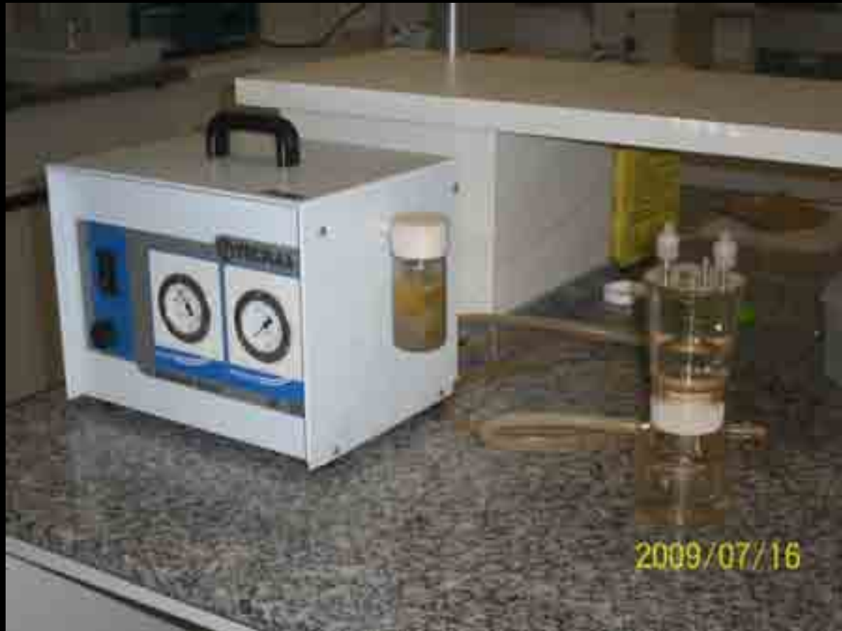
Figura 2. Processo de concentração das amostras com auxílio da bomba a vácuo. Foto: Joseane (bolsista-Feevale)
